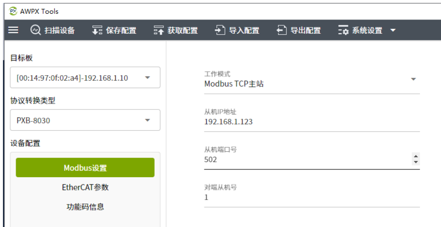
图 3.1 Modbus TCP 主站配置
